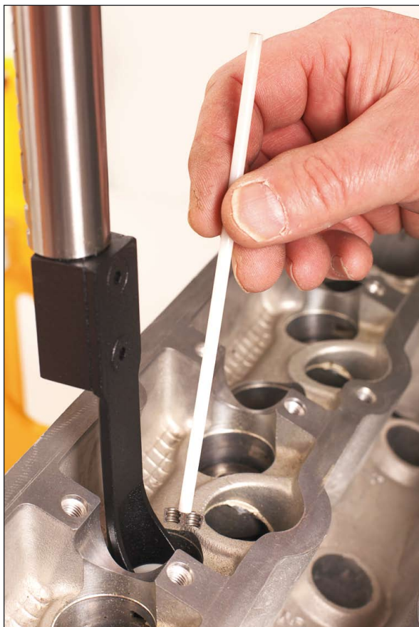
La rimozione dei semiconi è semplice con la apposita calamita.
