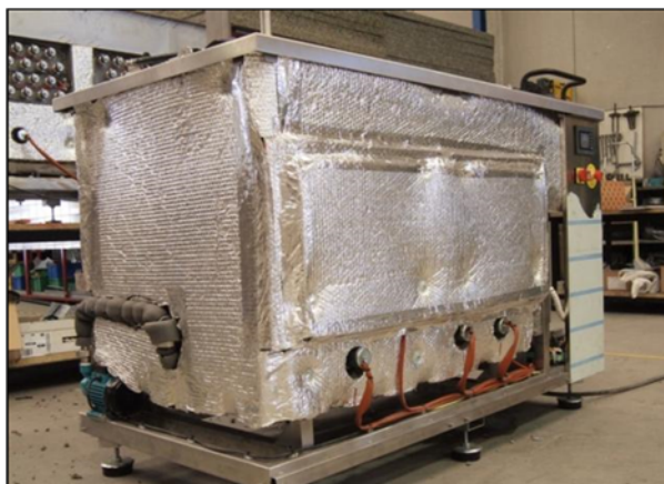
L'isolamento termico e acustico Ultratecno
